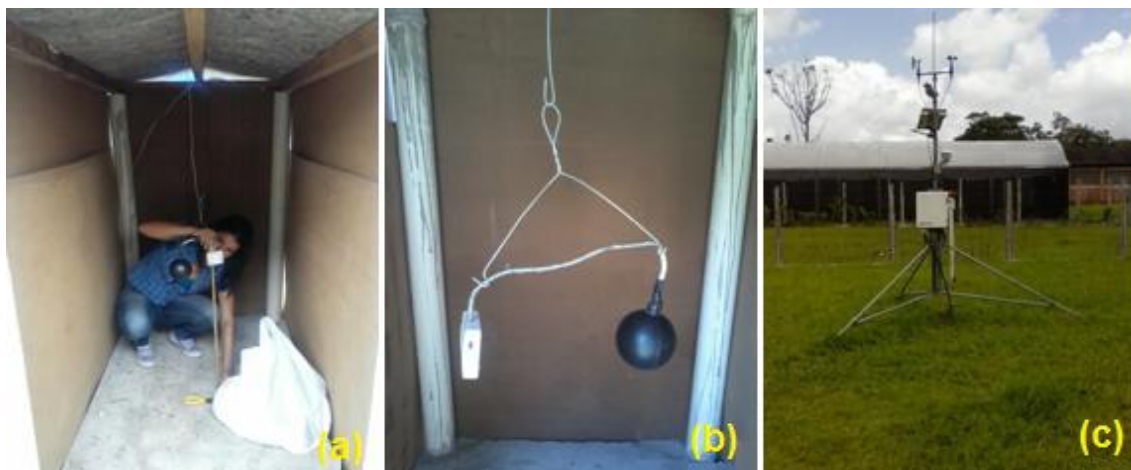
Figura 12. Sensores utilizados no experimento. (a) Sensores instalados no centro geométrico dos modelos reduzidos; (b) cabide confeccionado para separar os sensores; (c) estação meteorológica automática.
