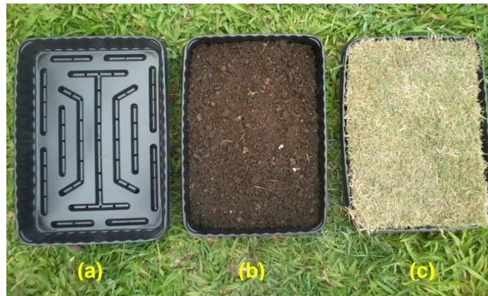
Figura 8. Etapas da montagem das bandejas de Zoysia japônica, para formação do telhado verde. (a) bandeja de plástico própria para grama; (b) preenchimento parcial da bandeja com substrato; (c) plantio da grama.
